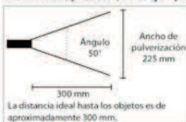
Núcleo de boquilla con microprecisión: El diámetro del orificio determina el volumen de material y, en consecuencia, la cantidad de pintura que ha de aplicarse.
